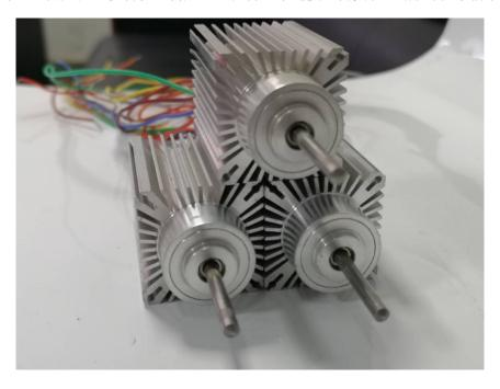
为什么说无刷电机在机械手臂中占有非常重要的角色呢?机械手臂注重刚度和精度设计;再就是机器人手臂是典型的机电一体化产品,在进行结构设计时必须要考虑到驱动、控制等方面的问题。而无刷电机是机械手臂的上游产品。俗语有言"上梁不正下梁歪","丈高楼从地起"这些都说明了基础性组成部分的重要性。机械臂关节用电机一直是这一领域的研究重点,电机的选取及其相关控制策略的应用在很大程度上影响着机械臂成本、机械手操作精度和机械臂的长期可靠运行。在众多机械臂关节用电机中,直流无刷电机以体积小,重量轻,使用寿命长,无碳刷,低噪音的优点得到了越来越多的使用到工业机械人系统上。变频无刷电机生产厂注意避免无刷电机因电流过大、温度变化及拆装时磁路开路等造成永磁体退磁。
